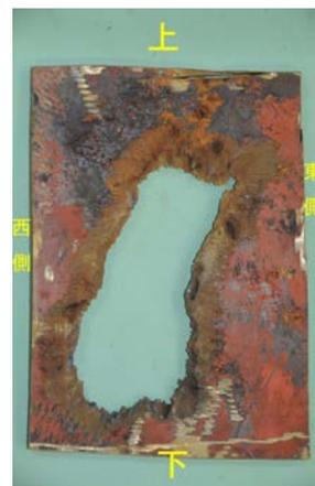
写真5 腐食開口部の試料
